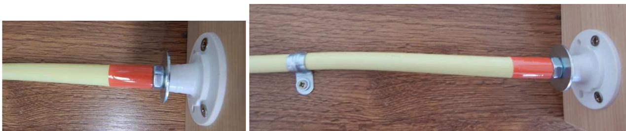
Beide Schlauchenden können in VPIH M8 Packer eingeschraubt und diese dann mit 2 geraden Nägeln an der Schalung festgeklemmt werden.
