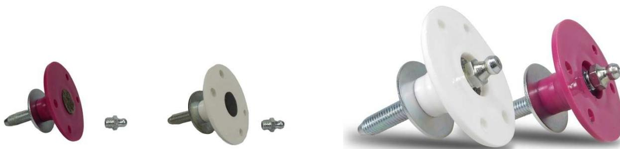
Eine weitere Variante ist der OPIH M8 Packer für einen 12/6 Injektionsschlauch. Diese Packer werden dort eingesetzt, wo der Schlauch aus der Schalung herausgeführt wird und die Injektion mit einem Verlängerungsschlauch 14/6 außerhalb des Bauwerks erfolgt.
